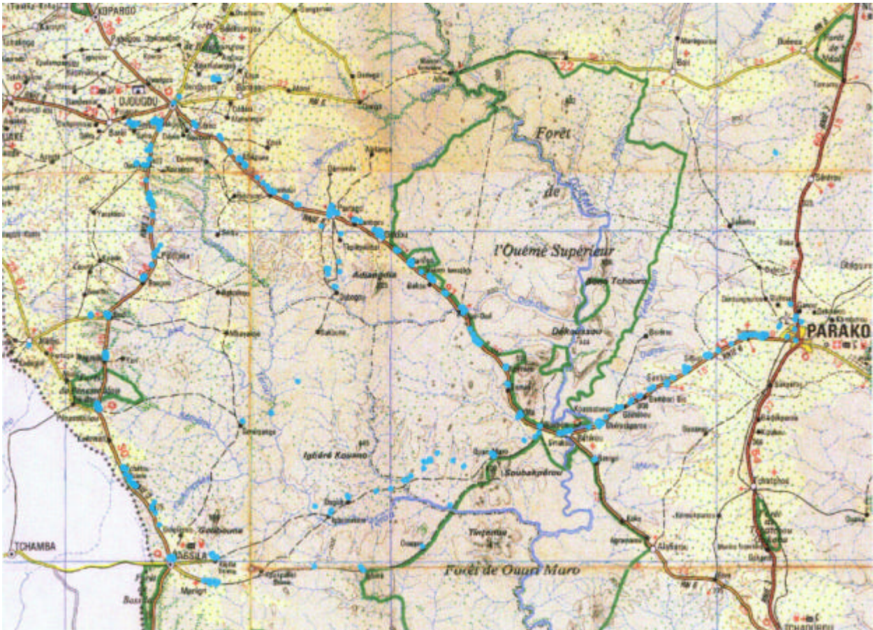
Abb. A5-1: ArcView Darstellung der Trinkwasserquellen im Untersuchungsgebiet zwischen Parakou, Djougou und Bassila. Die blauen Kreise entsprechen Clustern von georeferenzierten Brunnen und Oberflächengewässern, die erst bei grösserer Auflösung unterschieden werden können. Die Gesamtzahl der erfassten Einzelstandorte beläuft sich derzeit auf über 1000. (orientierender Massstab: Entfernung Parakou - Djougou ca. 130 km)
